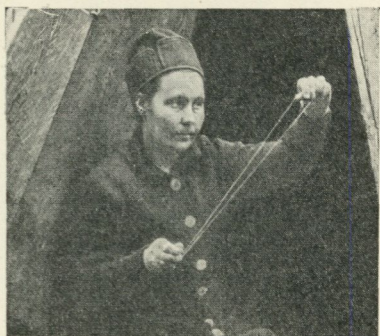
Fig. 5. Tråden nystas kring högra handloven för kontroll av sladdarnas samsning och för avlägsnande av möjligen befintliga knutar och snälor.
