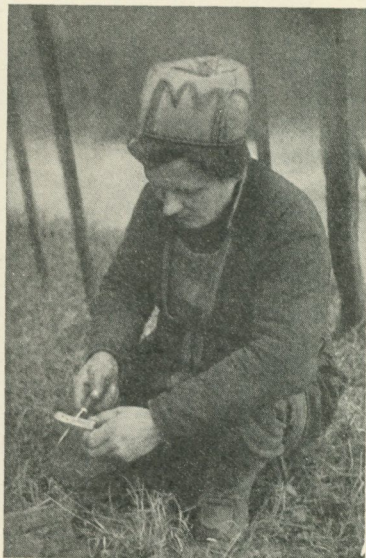
Fig. 18. Gjutaren knackar med knivbaken för att tennet skall rinna genom trästycket ned i hornformen.
