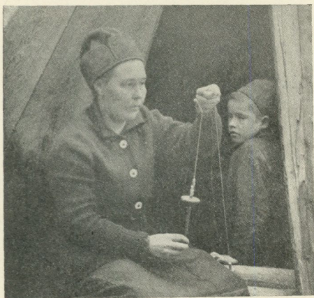
Fig. 12. En tenntråd och en sentråd hop-tvinnas medelst snaltie . Bilden tagen i det ögonblick, då snäldan förmedelst fingrarna sättes i roterande rörelse.
