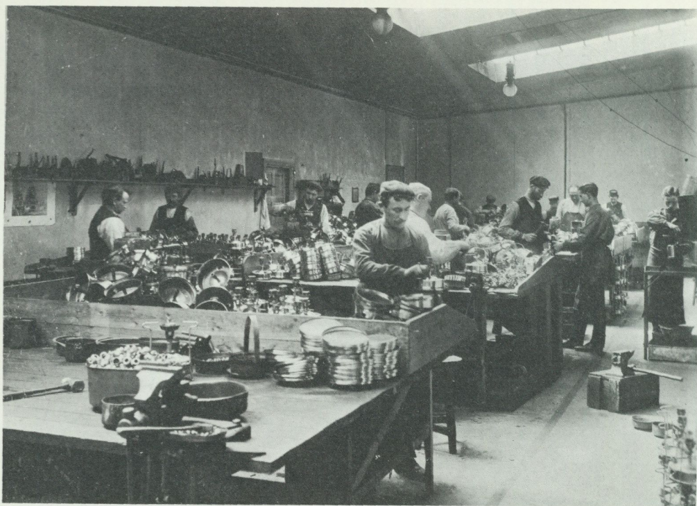
Primusköken var en av den "nya" verkstadsindustrins typiska produkter. Denna bild från seklets första år visar hur kökens olika delar monterades ihop.
